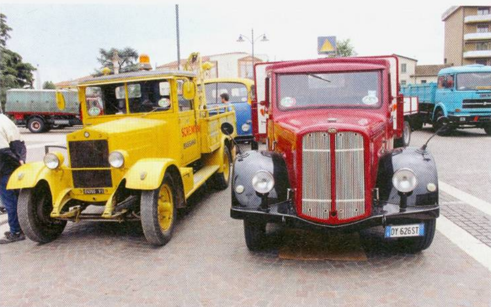
A gauche, un Fiat 621 mis en service au début des années 30 en Italie. C'était un camion de moyen tonnage à usages divers. Il était équipé d'un moteur Fiat 122A essence, 6 cylindres de 2,516 cm 3 et 45 chevaux. A droite, un OM Taurus construit entre 1938 et 1950. A l'arrière plan, un Fiat 170 NC d'une période bien plus récente que celle de ces merveilleuses pièces de collection.
