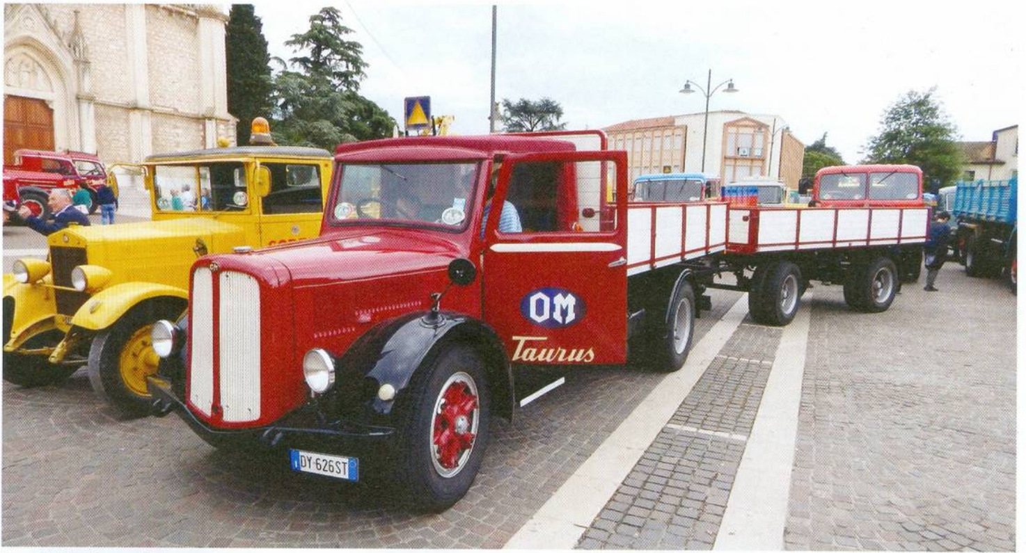
Le petit OM Taurus de la page 19 est vu sous un autre angle. On peut ainsi remarquer qu'il tracte une remorque équipée de roues jumelées aussi bien sur l'essieu avant que l'arrière. Le petit panneau bleu avec triangle jaune prévient les autres usagers qu'il s'agit d'un ensemble de plusieurs véhicules.
